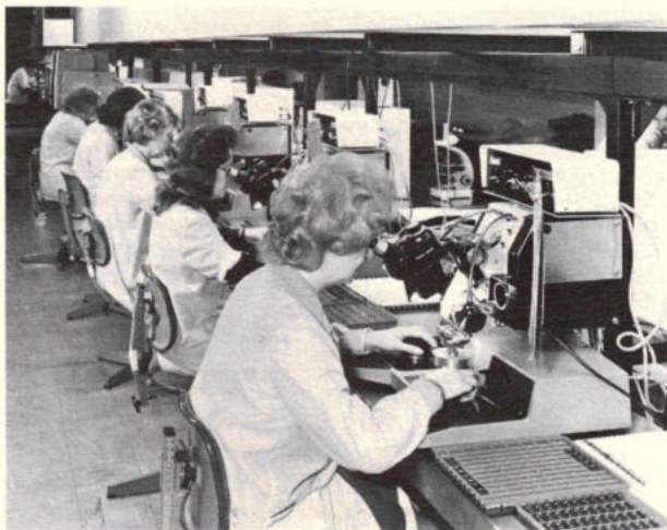
Afb. 4. Circuits op klantenspecificatie worden hier van chip-naar-pen bedrading voorzien. Rechts op de standaard is het bedradingsvoorschrift geplaatst. Uit de ronde opening van de „bonding-machine“ achter de lamp komt een aluminiumdraad met de halve dikte van een mensenhaar.
